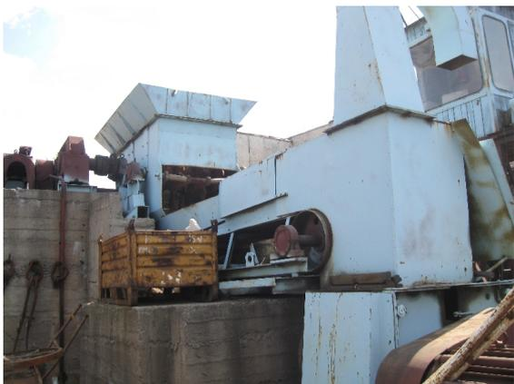
**Агрегат предназначен для дробления вьюнообразной стружки углеродистых марок сталей до размеров, необходимых для дальнейшего её брикетирования и переработки в ферросплавном производстве. Агрегат может работать при температуре окружающего воздуха от -40 до +40 градусов цельсия.**
