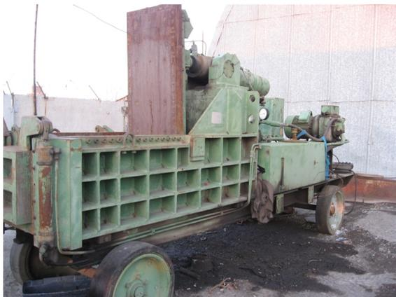
Комплекс механизмов "РИКО", дополняющих друг друга, обеспечивает большую экономию времени и совершенно безопасную работу. Гидравлический пресс "РИКО" модель С 12 предназначен для прессования черного и цветного металлолома толщиной до 3 мм.
